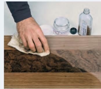
Oberflächenbehandlung der Naturholzgehäuse mit Pflegeöl auf natürlicher Basis
