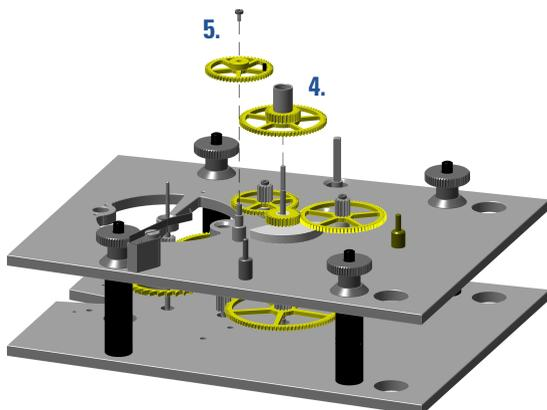
Zuerst setzen Sie das Stundenrad (4.) auf die Minutenradwelle auf. Im zweiten Schritt wird das Schaltrad (5.) auf das Schaltradpföstchen gesetzt und von oben mit einer M1,4x3 Zylinderkopfschraube gesichert.
